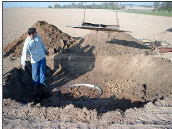
Photo 8 : Cylindre enfoncé ; retrait de la plaque acier
